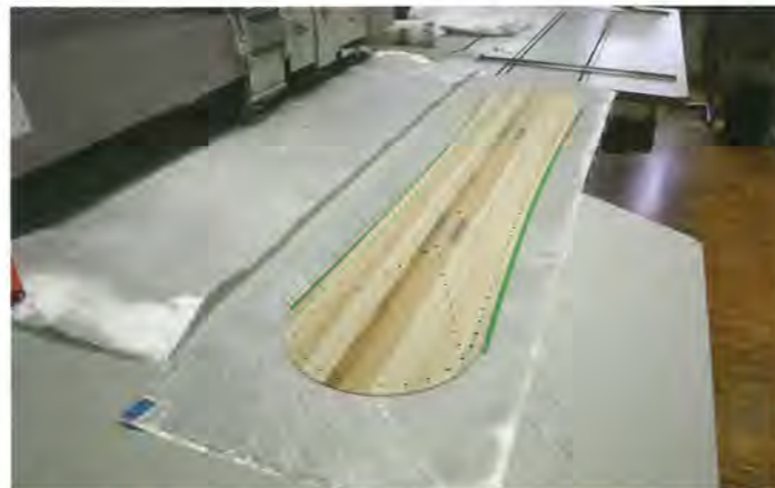
Einbringen von dreidimensionalen Verstärkungselementen am Beispiel eines Snowboard-Halbzeugs mit Hilfe einer CNC-gesteuerten Stickmaschine am IHD Dresden.
